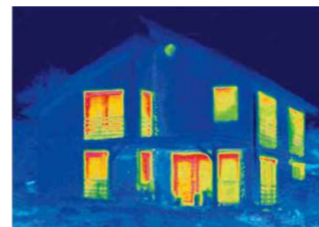
Fotos de infrarrojos y termografías muestran claramente por dónde una casa pierde energía de forma incontrolada. Rojo significa calor y por tanto pérdida de energía.
